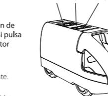
**Funciona con pilas:** Cuando el niño presiona en la parte del botón de "avance", el motor avanzará hacia adelante. Si pulsa el botón en la dirección de "retroceso", el motor funcionará a la inversa.
